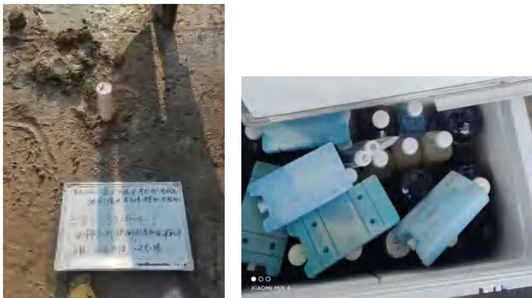
图 5.2-3 部分地下水建井和地下水样品照片
