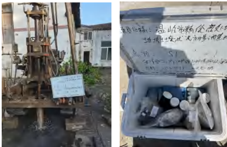
图 5.2-2 部分土孔钻探及土壤样品照片
