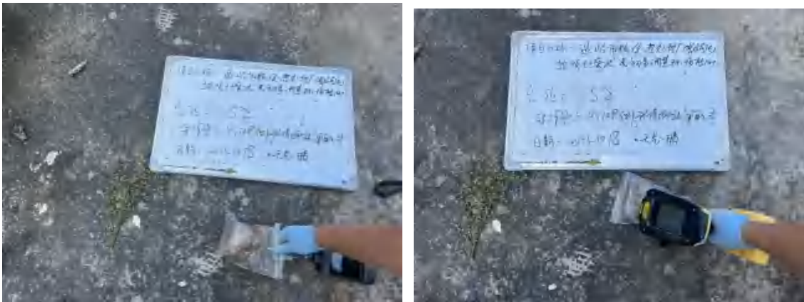
图 5.2-4 部分土壤现场快速检测图
