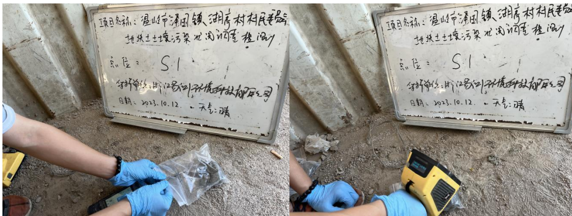
图 5.1-3 部分土壤现场快速检测图
