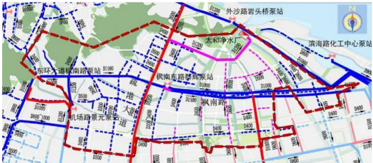
图 2-1 枫南路污水系统管网泵站分布图
