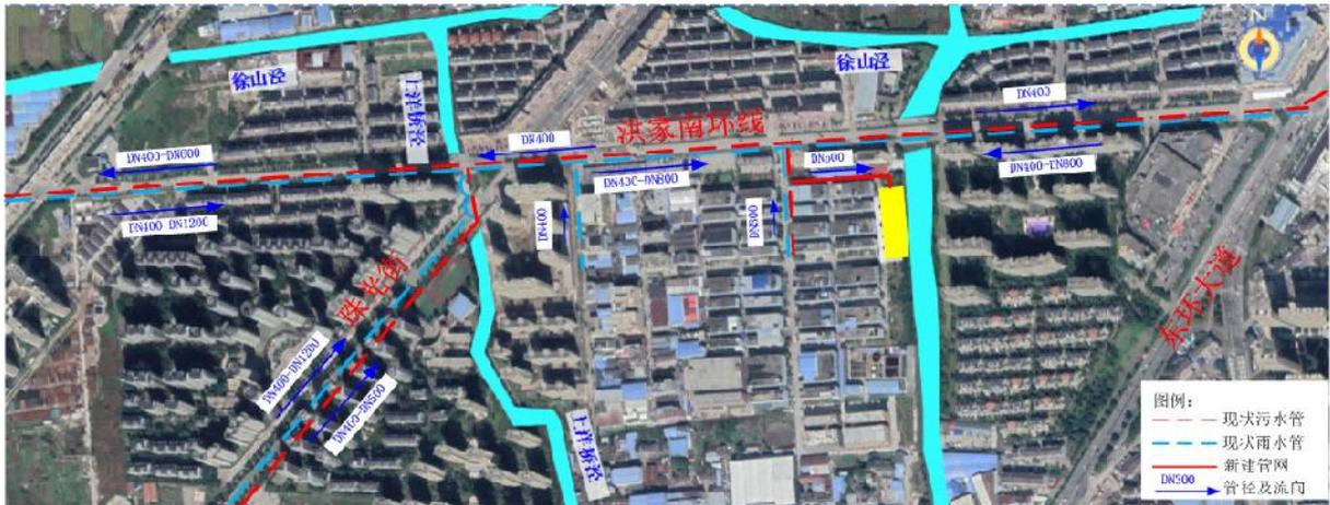
图 2.1-3 洪家南环线互联互通管及进应急处理设施主管线示意图
