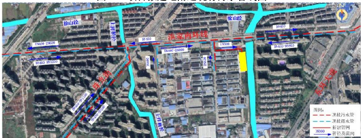
图 2-4 洪家南环线互联互通管及进应急处理设施主管线示意图
